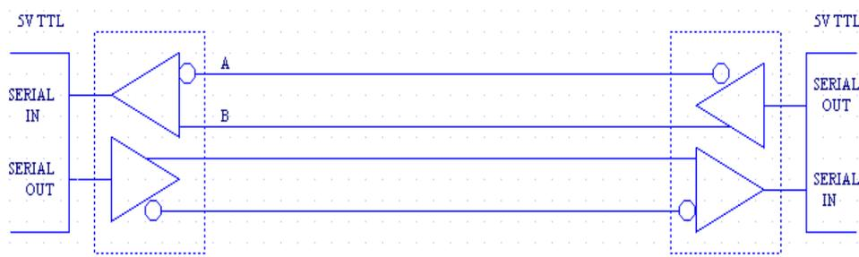
En la siguiente figura se muestra como es posible utilizar la comunicación Full Duplex con múltiples nodos transmisores y receptores.
