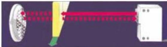
e) **Sensores de detección difusa.** Cuando la luz es reflejada difusamente por el objeto y es detectado por el hecho de que el transmisor y receptor son lentes divergentes, y se usan para detectar objetos muy próximos (1.5 m de alcance).
