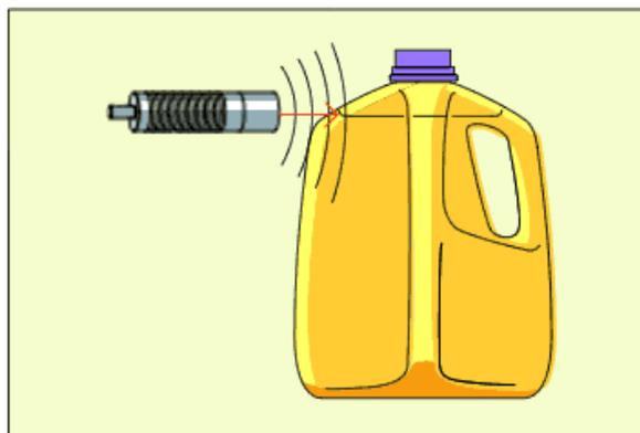
Una aplicación para los sensores de proximidad capacitivos es la detección de nivel a través de barreras.
